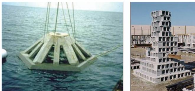
**Figura 1.4.11** Módulos polivalentes de hormigón para arrecifes. La fotografía de la derecha muestra una unidad de protección con elementos de disuasión así como cavidades, para incrementar la biomasa.
