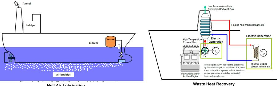
**Hull Air Lubrication**
